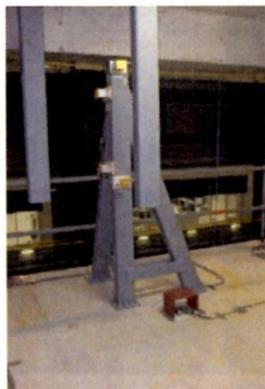
床応答加速度、層間変位の計測
