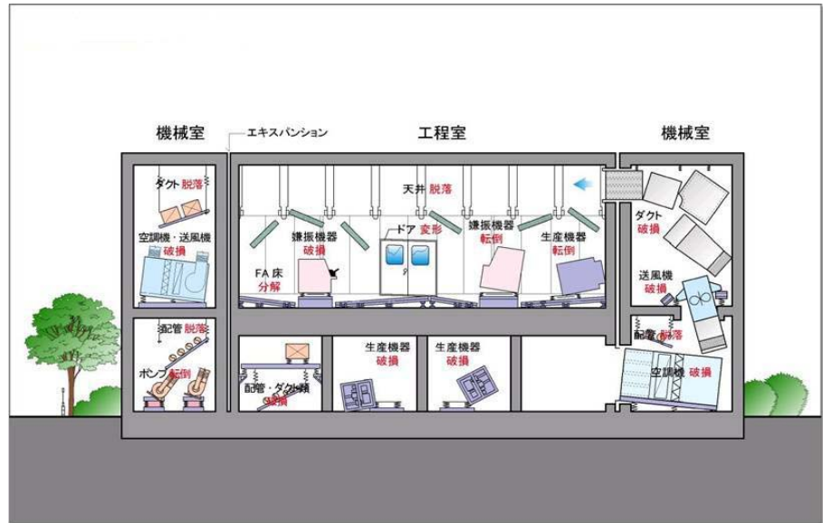
図1 工場の被災例
